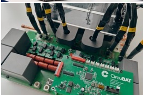
Convertisseur CC/CC hautement efficace pour les systèmes de stockage de batteries de seconde vie et d'autres applications. Production et vente par https://www.indrivetec.com/contact-us ©Simon Nigsch, OST.
