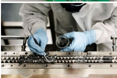
Bühler AG et Empa ont développé un nouveau procédé industriel sans solvant réduisant l'empreinte environnementale et le coût de la production d'électrodes pour batteries. ©Gianfranco Guidati.
