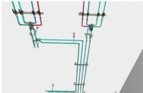
*Le BIM pour la préfabrication d'installations sanitaires : le modèle de fabrication 3D (à g.) et les tuyauteries de distribution installées. / Texte complémentaire par ots et sur [www.presseportal.ch/fr/nr/100063290](http://www.presseportal.ch/fr/nr/100063290) / L'utilisation de cette image à des fins éditoriales est autorisée et gratuite, pourvu que toutes les conditions d'utilisation soient respectées. La publication doit inclure le crédit de l'image.*
