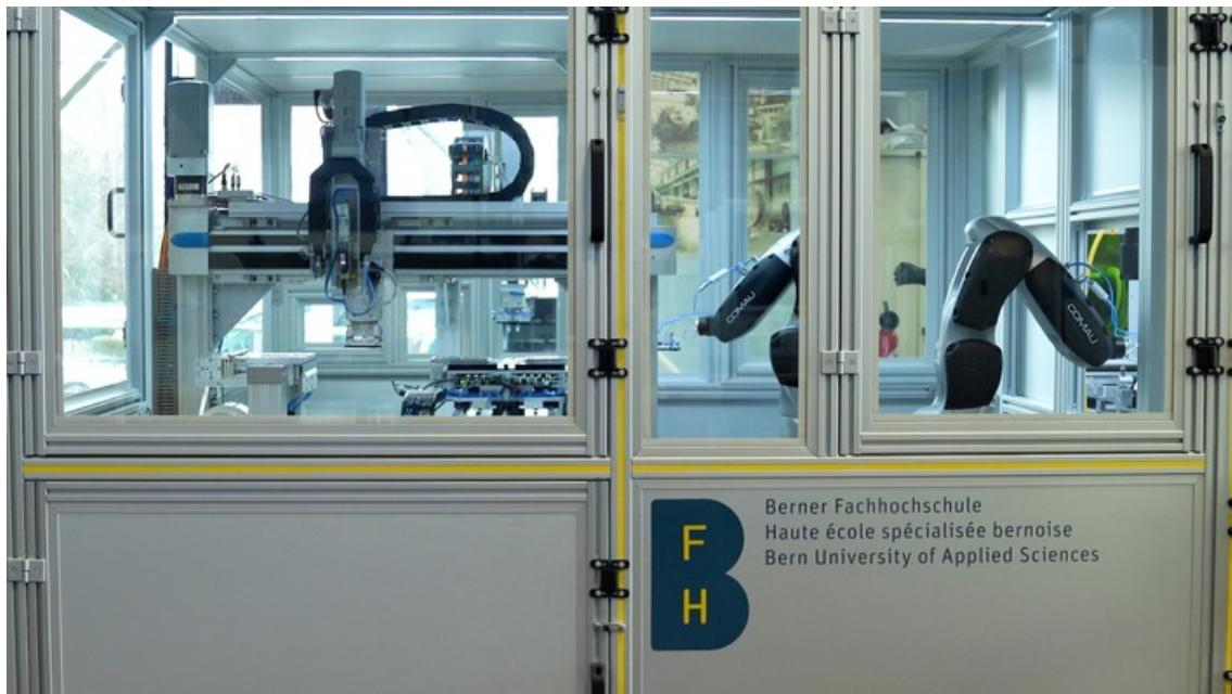
La Haute école spécialisée bernoise BFH a construit une installation de recherche tout à fait unique en Suisse pour la production plus efficace et durable de batteries lithium-ion. Outre des optimisations du processus de production, elle permet de fabriquer des cellules de batterie allant d'une taille de 15x30 cm à celle d'une carte de crédit. L'installation sera inaugurée le 18 novembre 2021 à Berthoud.
