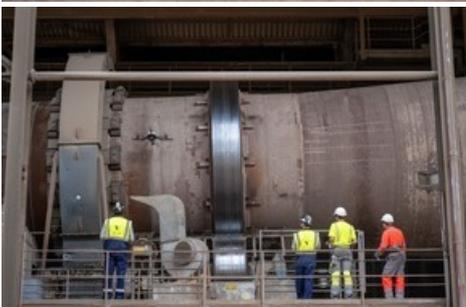
Mesures de les épaisseurs des parois en acier du four à ciment. ©Voliro
