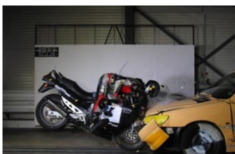
*Le choc à la tête est réduit à 35 % de la valeur limite biomécanique et sur le thorax à 50 % par rapport à un accident en scooter. Les valeurs limites biomécaniques des contraintes sur le bassin n'ont pas été dépassées malgré le comportement non optimisé du réservoir vis-à-vis de la défaillance par déformation.*
