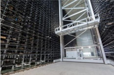
*Avec ses 40 mètres de long, 21 mètres de haut et 25 mètres de large, la nouvelle unité de stockage en hauteur de Debrunner Acifer AG Birsfelden dispose de 3'000 emplacements pour 9'000 tonnes d'acier. Texte complémentaire par ots et sur [www.presseportal.ch/fr/nr/100053189](http://www.presseportal.ch/fr/nr/100053189) / L'utilisation de cette image est pour des buts rédactionnels gratuite. Publication sous indication de source: "obs/Debrunner Acifer AG/zvg"*
