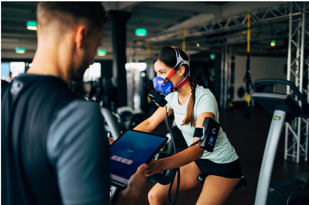
Bild 1: Mit der uVida Stoffwechselanalyse wird mithilfe einer Maske der Atem im Ruhezustand und bei Belastung jeweils zwischen fünf und zwanzig Minuten analysiert.
