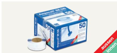
Von Hand formbare Manschette. Einseitig klebendes, hochflexibles Butylkautschukband für die dauerhafte, einfache Abdichtung von Durchdringungen. Breite 50 mm.
