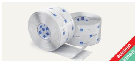
Putzanschlussband für den luftdichten Anschluss von Dampfbremsen oder Unterdeckbahnen an unverputztes Mauerwerk oder Beton. Einseitig vollflächig klebend. Verputzbar. Linerteilung 40/60 mm.
