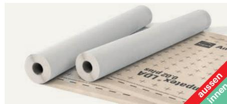
Dreilagige hochdiffusionsoffene Luftdichtheitschicht in der Dachsanierung über der Tragkonstruktion. Diese Bahn ist sehr diffusionsoffen (s<sub>d</sub>-Wert: 0,025 m) und trotzdem luftdicht (a-Wert: 0,004). Mit beidseitig integrierten Tapes.
