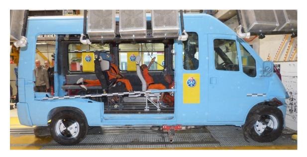
La fotografia mostra il veicolo con i manichini usato nel test dopo l'impatto.
