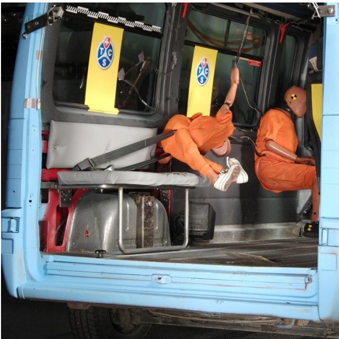
Bild oben: Der nicht angegurte Dummy wird gegen den Fahrersitz und Tür geschleudert. Der auf der Längsbank mit Beckengurt gesicherte Dummy wird, bedingt durch einen Defekt des Gurtrollers, erst spät zurückgehalten.
