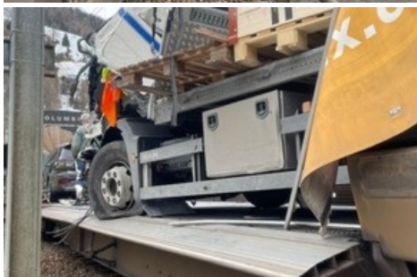
Schäden nach verrutschtem Lastwagen auf Autozug.
