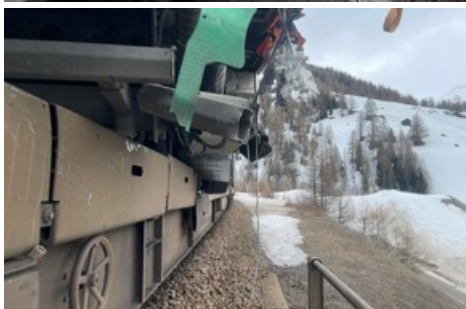
Schäden nach verrutschtem Lastwagen auf Autozug.
