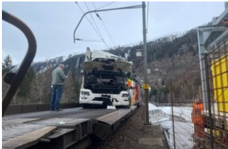
Schäden nach verrutschtem Lastwagen auf Autozug.
