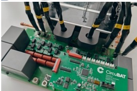
Hocheffizienter DC/DC Converter für Second-Life Battery Storage Systems und weitere Anwendungen. Produktion und Verkauf durch https://www.indrivetec.com/contact-us ©Simon Nigsch, OST.
