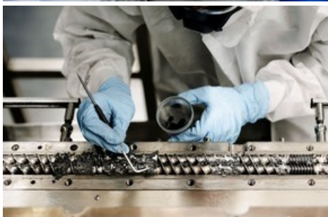
Die Bühler AG und die Empa haben ein neues lösungsmittelfreies Herstellungsverfahren entwickelt, das die Umweltbelastung und die Kosten der Batterieelektrodenproduktion reduziert. ©Gianfranco Guidati.
