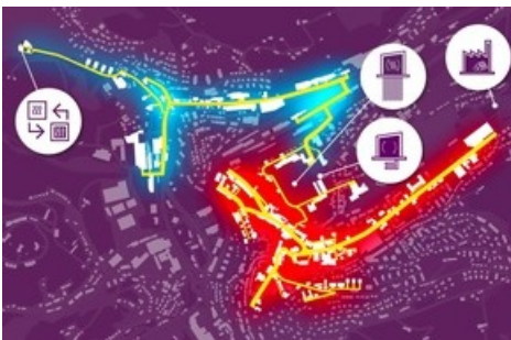
Links oben: Wärmeauskopplung ARA Bachwis, Mitte: Erdsondenfeld und Wärmepumpenzentrale Ebnet. Rechts oben: Holzheizkraftwerk Kreckel (Bild: SAK).
