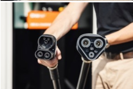
Größenvergleich: Links der CCS-Typ-2-Stecker, rechts der deutlich grössere MCS-Ladestecker für die Megawatt-Ladung von E-LKW. / © Designwerk Technologies AG
