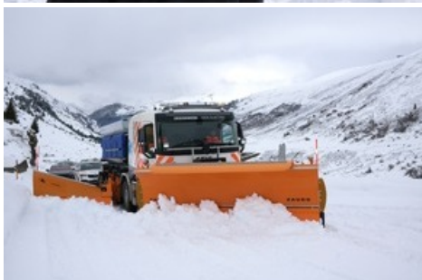
Kolossale Kulisse: Elektro-Schneepflug mit 750 kWh auf 2000 Metern ü.M. | Designwerk Technologies AG ©
