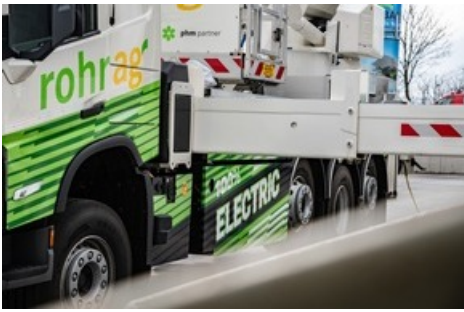
Vollelektrischer Antrieb des Krans, die Arbeitsplattform und ausfahrbare Stützen | Designwerk Technologies AG ©
