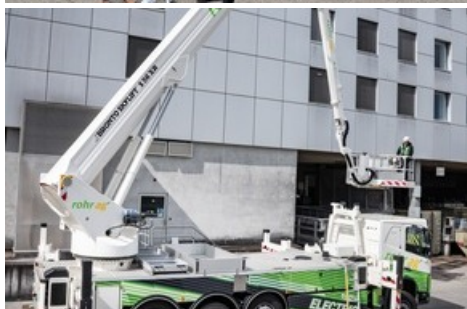
Der elektrische Nebenantrieb liefert die nötige Kraft für anspruchsvolle Hubarbeiten | Designwerk Technologies AG ©
