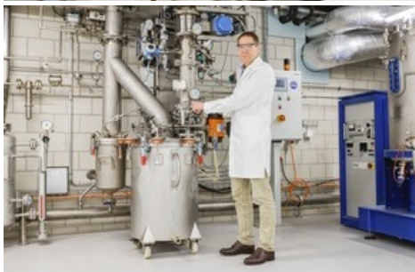
Michael Studer mit der «Steam gun»: Mit dieser Anlage wird Biomasse aufgeschlossen, damit sie anschliessend biotechnologisch umgewandelt werden kann. (Foto: Reto Baula)
