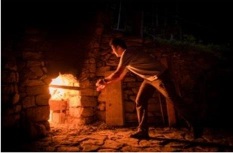
Der Kalkofen wird rund um die Uhr überwacht, um die notwendige Brenntemperatur von ca. 1'000°C aufrecht zu erhalten. / Weiterer Text über ots und [www.presseportal.ch/de/nr/100072441](http://www.presseportal.ch/de/nr/100072441) / Die Verwendung dieses Bildes für redaktionelle Zwecke ist unter Beachtung aller mitgeteilten Nutzungsbedingungen zulässig und dann auch honorarfrei. Veröffentlichung ausschließlich mit Bildrechte-Hinweis.
