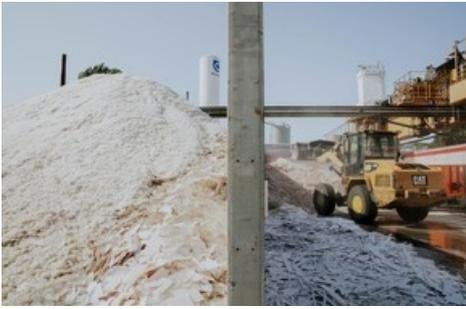
Der interne Wertstoffkreislauf ist bei SCHOTT bereits sehr gut ausgeprägt. Über 90 Prozent der anfallenden Glasscherben gehen wieder in die Glasschmelze. Foto: SCHOTT / Weiterer Text über ots und [www.presseportal.de/nr/23114](http://www.presseportal.de/nr/23114) / Die Verwendung dieses Bildes für redaktionelle Zwecke ist unter Beachtung aller mitgeteilten Nutzungsbedingungen zulässig und dann auch honorarfrei. Veröffentlichung ausschließlich mit Bildrechte-Hinweis.
