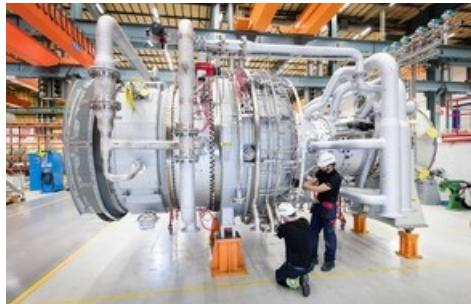
*Fertigung einer Gasturbine SGT 800 - Quelle: <https://press.siemens-energy.com/> / Weiterer Text über ots und [www.presseportal.de/nr/100391](http://www.presseportal.de/nr/100391) / Die Verwendung dieses Bildes für redaktionelle Zwecke ist unter Beachtung aller mitgeteilten Nutzungsbedingungen zulässig und dann auch honorarfrei. Veröffentlichung ausschließlich mit Bildrechte-Hinweis.*
