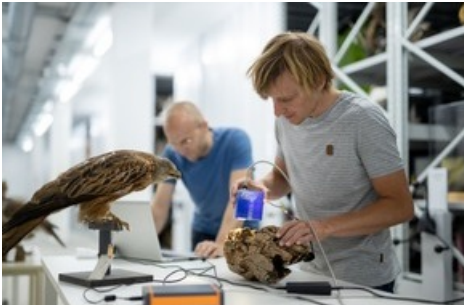
BILD zu OTS - Klaus Hochradel (li.) und Christof Happ vom Institut für Mess- und Sensor?technik arbeiten an einem Kamerasystem, um Schlagopfer rund um Windkraftanlagen automatisiert zu detektieren.
