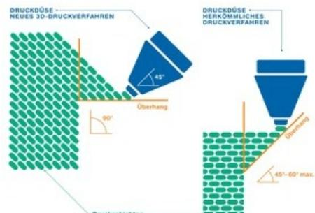
3D-Druckverfahren mit 45-Grad-Druckdüse und zusätzlicher Rotationsachse
