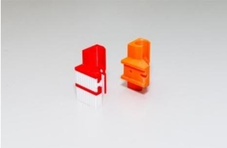
Zum Vergleich: Das Bauteil links wurde im herkömmlichen 3D-Druckverfahren hergestellt - mitsamt dem notwendigen Stützmaterial, das manuell entfernt werden muss. Das Bauteil rechts wurde mit dem neuen Verfahren gedruckt und benötigt keine Nachbearbeitung.
