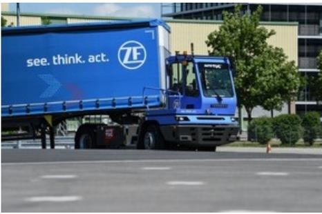
Zugmaschinen können draußen bleiben: Der autonome Terminal Yard Tractor von ZF rangiert Sattelaufleger auf definierten Arealen selbständig an die Rampe und wieder zurück. Weiterer Text über ots und [www.presseportal.de/nr/66240](http://www.presseportal.de/nr/66240) / Die Verwendung dieses Bildes ist für redaktionelle Zwecke honorarfrei. Veröffentlichung bitte unter Quellenangabe: "obs/ZF Friedrichshafen AG/Felix Kaestle"
