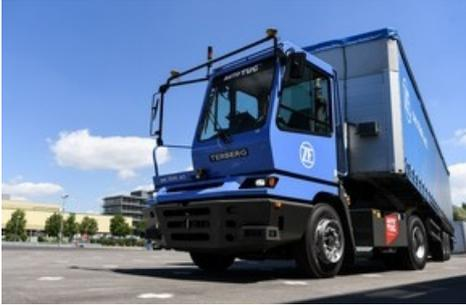
Zugmaschinen können draußen bleiben: Der autonome Terminal Yard Tractor von ZF rangiert Sattelaufleger mit der Funktion SemitrailerAssist auf definierten Arealen selbständig an die Rampe und wieder zurück. Weiterer Text über ots und [www.presseportal.de/nr/66240](http://www.presseportal.de/nr/66240) / Die Verwendung dieses Bildes ist für redaktionelle Zwecke honorarfrei. Veröffentlichung bitte unter Quellenangabe: "obs/ZF Friedrichshafen AG/Felix Kaestle"
