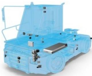
Systemkompetenz von ZF macht Logistik intelligent: Das erweiterte Sensor-Set lässt den Terminal Yard Tractor seine Umgebung im Blick behalten, der Zentralcomputer ZF ProAI koordiniert alle Funktionen der Längs- und Querführung. Weiterer Text über ots und [www.presseportal.de/nr/66240](http://www.presseportal.de/nr/66240) / Die Verwendung dieses Bildes ist für redaktionelle Zwecke honorarfrei. Veröffentlichung bitte unter Quellenangabe: "obs/ZF Friedrichshafen AG/Felix Kästle"
