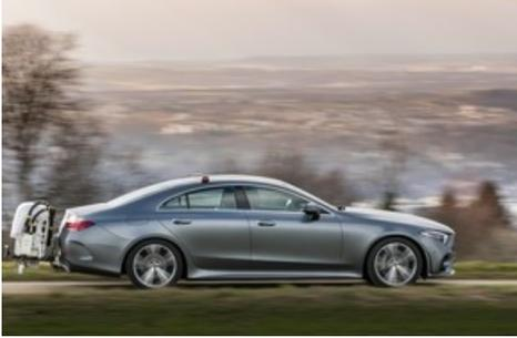
CLS-Klasse mit PEMS (Portable Emission Measurement System)-Anlage // CLS-Class with PEMS (Portable Emission Measurement System) device. Weiterer Text über ots und [www.presseportal.ch/de/nr/100001544](http://www.presseportal.ch/de/nr/100001544) / Die Verwendung dieses Bildes ist für redaktionelle Zwecke honorarfrei. Veröffentlichung bitte unter Quellenangabe: "obs/Mercedes-Benz Schweiz AG/Daimler AG - Global Communicatio"
