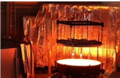
*Vier der fünf Spiegel des Extremely Large Telescopes werden aus ZERODUR® Glaskeramik von SCHOTT gefertigt. Weiterer Text über ots und [www.presseportal.de/nr/23114](http://www.presseportal.de/nr/23114) / Die Verwendung dieses Bildes ist für redaktionelle Zwecke honorarfrei. Veröffentlichung bitte unter Quellenangabe: "obs/SCHOTT AG/Foto: SCHOTT"*
