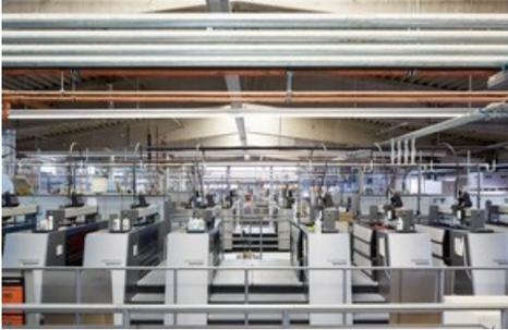
*Blick in den Maschinenpark von Onlineprinters am Standort Neustadt an der Aisch. Hier stehen Offsetdruck-Maschinen mit insgesamt 121 Druckwerken. Weiterer Text über ots und [www.presseportal.ch/de/nr/100053081](http://www.presseportal.ch/de/nr/100053081) / Die Verwendung dieses Bildes ist für redaktionelle Zwecke honorarfrei. Veröffentlichung bitte unter Quellenangabe: "obs/Onlineprinters GmbH"*
