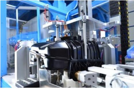
*Röchling Automotive: Funktionstest eines SCR-Tanksystems. Weiterer Text über ots und [www.presseportal.de/nr/51987](http://www.presseportal.de/nr/51987) / Die Verwendung dieses Bildes ist für redaktionelle Zwecke honorarfrei. Veröffentlichung bitte unter Quellenangabe: "obs/Röchling SE & Co. KG"*
