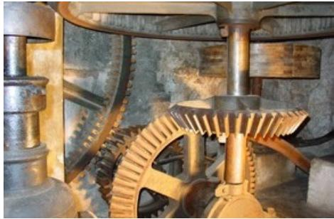
Teilnehmende Anlage Lochmühle Welschenrohr, Kammrad und Wellen und Kegelradgetriebe / Weiterer Text über ots und www.presseportal.ch/de/nr/100019712 / Die Verwendung dieses Bildes ist für redaktionelle Zwecke honorarfrei. Veröffentlichung bitte unter Quellenangabe: "obs/Vereinigung Schweizer Mühlenfreunde (VSM/ASAM)/VSM/ASAM Teilnehmende Anlage"
