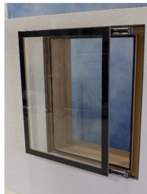
Bild 8: Typ D - Abstell-Schiebe-Fenster mit Teleskopauszügen, Holzforschung Austria
