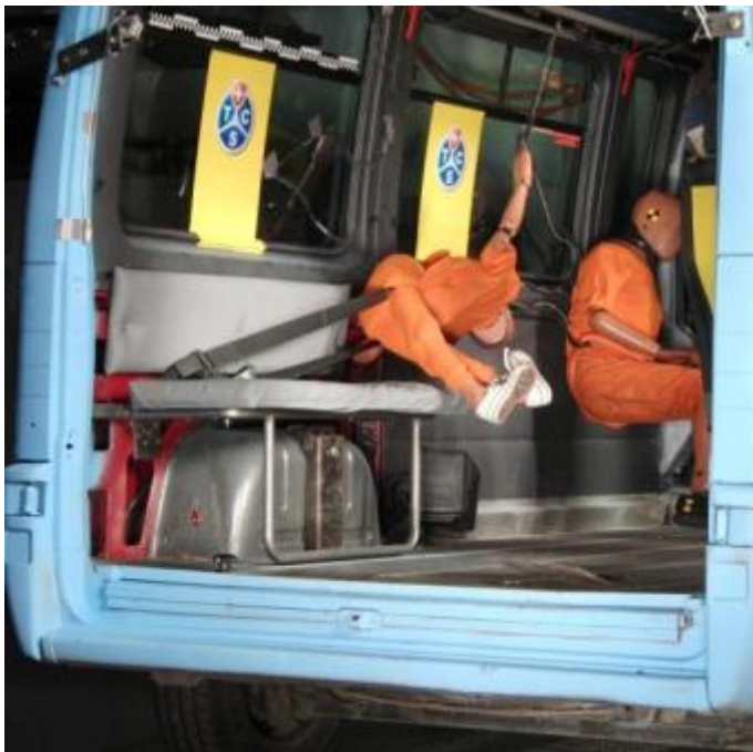
Photo ci-dessus: le mannequin non attaché est projeté contre le siège du conducteur et la porte. Suite à une rupture de l'enrouleur, le mannequin attaché avec une ceinture ventrale est retenu trop tardivement.
