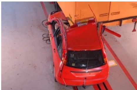
crash _ zentrum lkw unterfahrschutz
