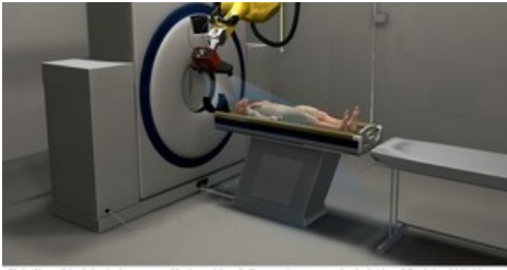
Ein hochbeweglicher Industrieroboter namens «Virtobot» zeichnet die Konturen einer zu untersuchenden Leiche auf. Durch den gleichzeitigen Einsatz von Computertomographen erhalten die Gerichtsmediziner ein dreidimensionales Bild und können die Leichen digital konservieren. © Zemanova Forensic Biology and Virtoppy, Institut für Rechtsmedizin der Universität Bonn/5N Abdruck mit Zustimmung und nur zu redaktionellen Zwecken. Un robot industriel extrêmement souple, baptisé «Virtobot», enregistre les formes du cadavre à examiner. Le recours simultané à la tomodesitométrique fournit aux médecins légistes une image en trois dimensions, permettant ainsi la conservation numérique des corps.
