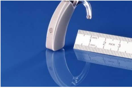
Smile 100, das erste vollautomatische Hörgerät ohne Schalter und Regler
